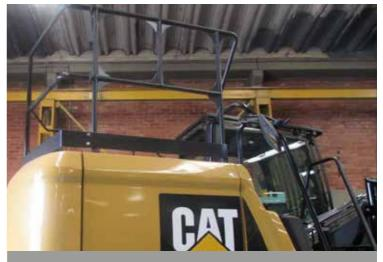
PROTEÇÃO SUPERIOR, LATERAL E TANQUE ADICIONAL
